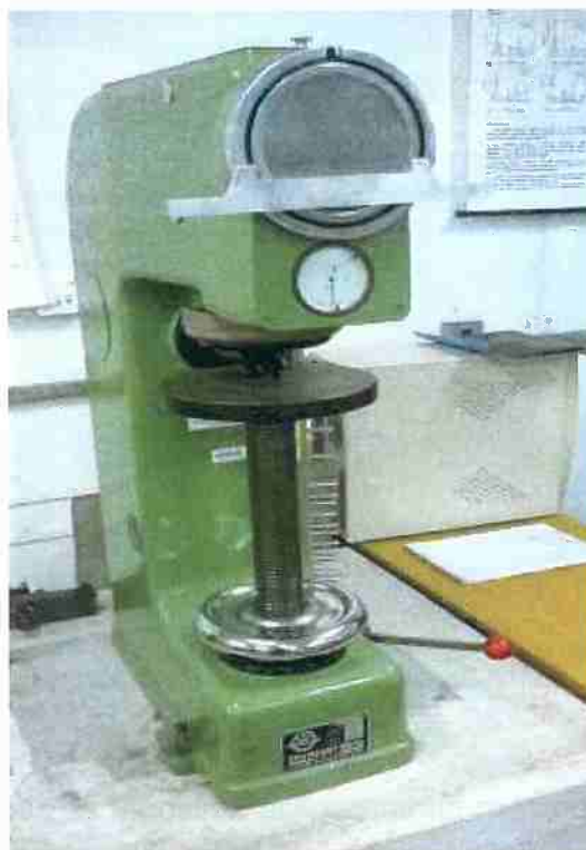
Figura 7 – Durômetro utilizado no ensaio de dureza Vickers.
