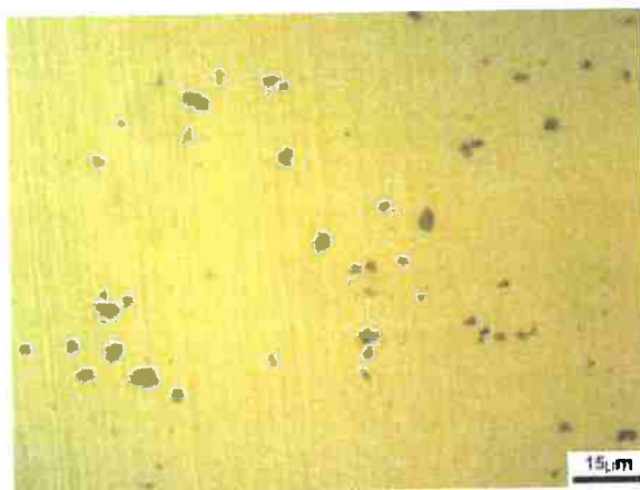
Figura 22 – Amostra envelhecida (T5), com 60% de redução em área, 1000x.
