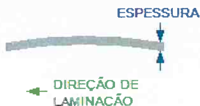
Figura 10 – Desenho ilustrativo da seção longitudinal da amostra.
