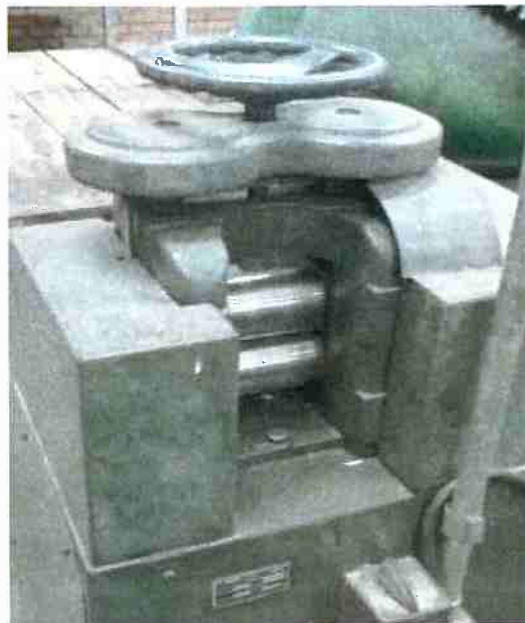
Figura 8 – Laminador utilizado no processo de laminação.
