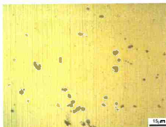
Figura 26 – Amostra Solubilizada, com 60% de redução em área, 1000x.
