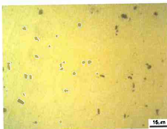
Figura 23 – Amostra envelhecida (T5), com 90% de redução em área, 1000x.
