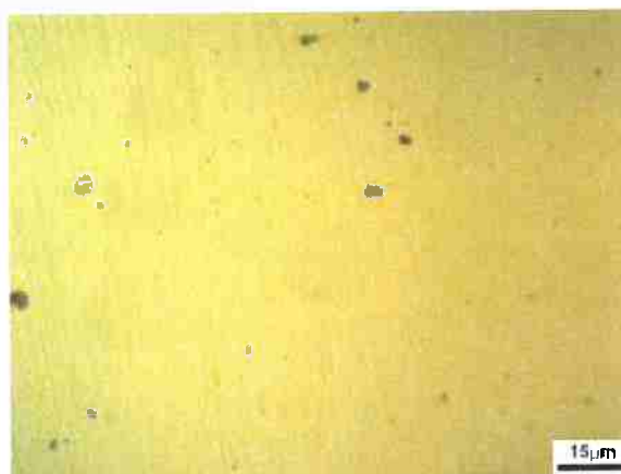
Figura 20 – Amostra envelhecida (T5), com 0% de redução em área, 1000x.
