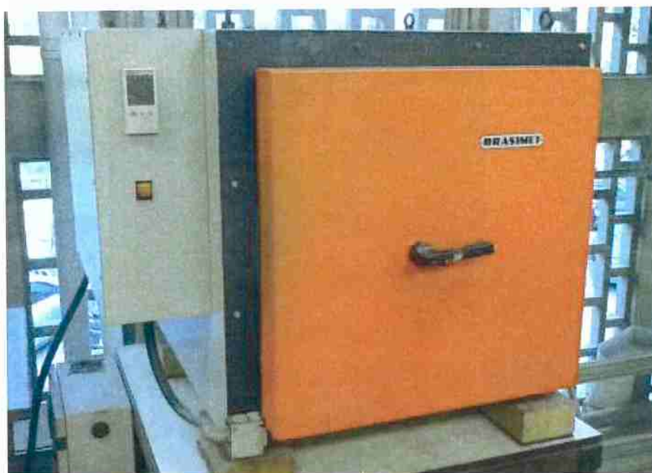
Figura 6 – Forno utilizado no tratamento de solubilização.
