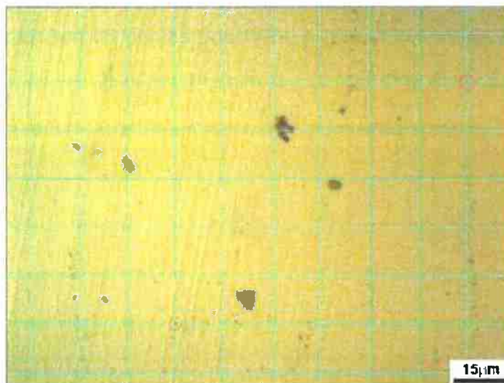
Figura 29 – Contagem manual de pontos da amostra A6.
