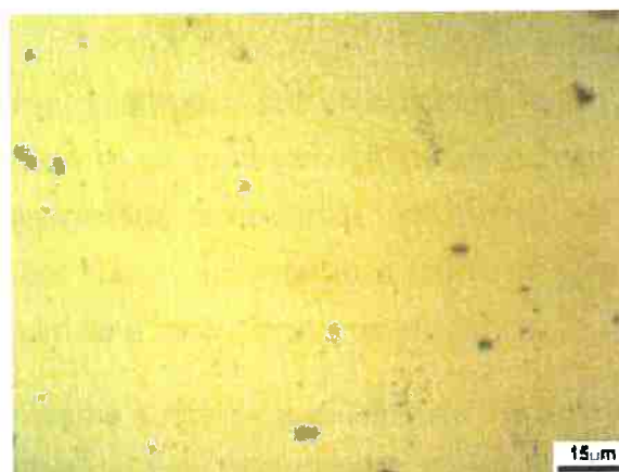
Figura 25 – Amostra Solubilizada, com 30% de redução em área, 1000x.
