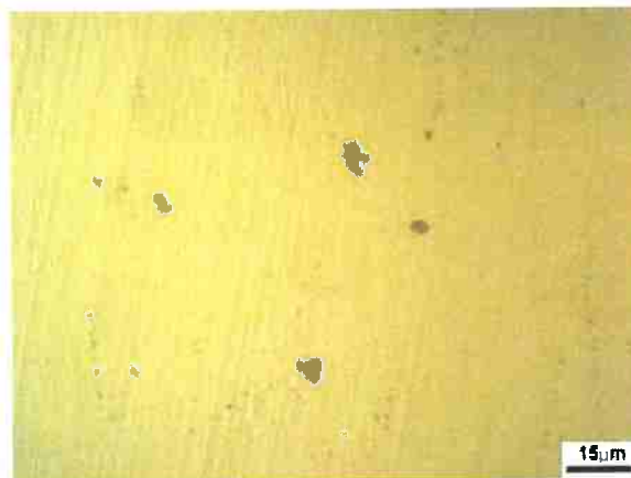
Figura 21 – Amostra envelhecida (T5), com 30% de redução em área, 1000x.
