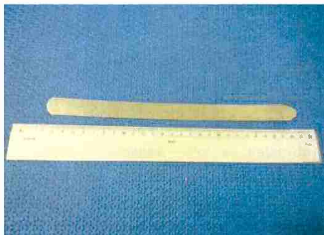
Figura 13 – Corpo de prova com 90% de redução em área.
