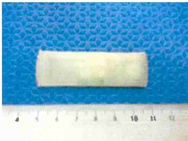
Figura 11 – Corpo de prova com 60% de redução em área.
