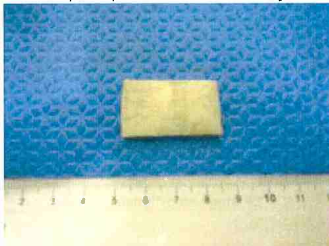
Figura 9 – Corpo de prova com 30% de redução em área.
